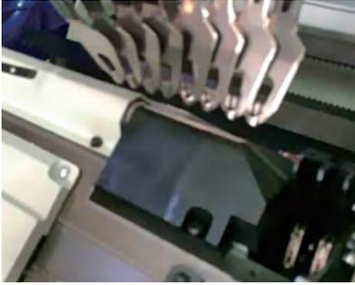
剪刀清洁装置: 自动清除剪刀夹子的线头
