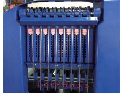
新款侧天线: 对喂纱状态始终保持快速灵敏的感应控制, 以维持稳定的纱线张力。
